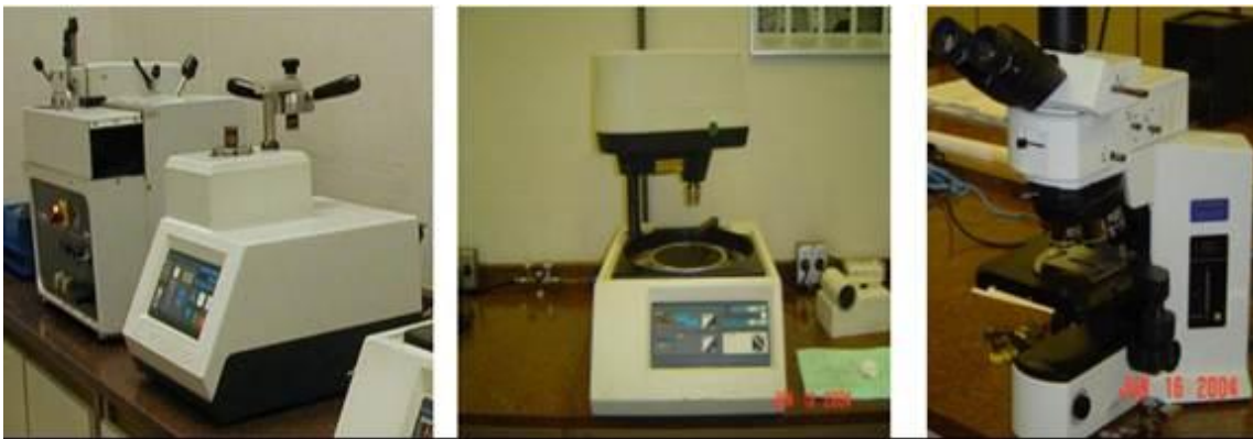
Figura 4. Fotografias da maquina de corte e de Embutimento, politriz e do Microscópio Óptico.
