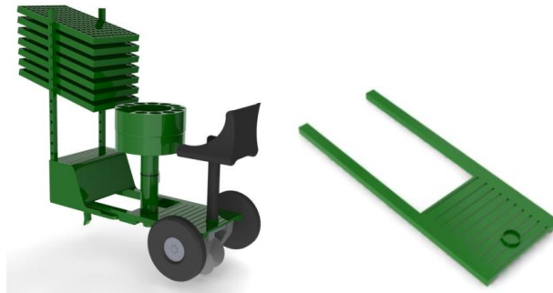
Figura 2 – Esboço da Transplantadora de Mudas. Fonte: Grupo de Projeto, 2011.
