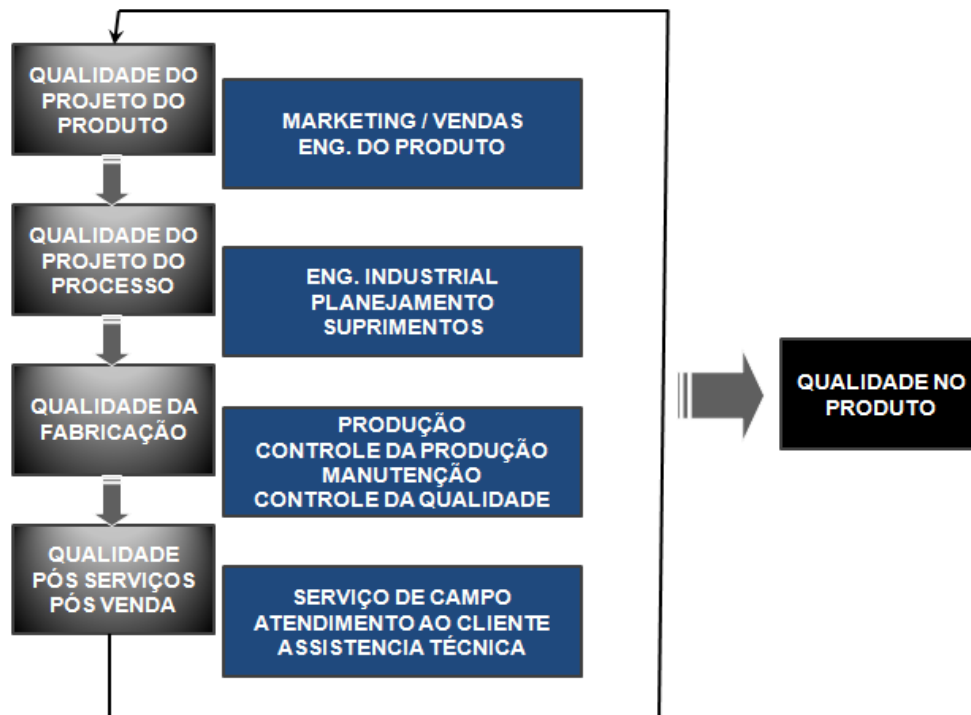
Figura 1 – Etapas do ciclo de produção. Fonte: Elaborado pelos autores a partir de TOLEDO apud RIBEIRO, 2003.
