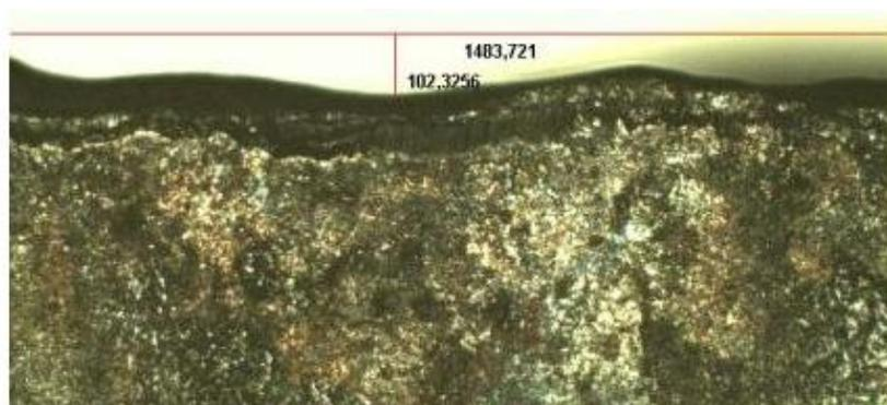
Figura 8. Ampliação de 50 vezes (desgaste de flanco de 102,3256  $\mu$ ).
