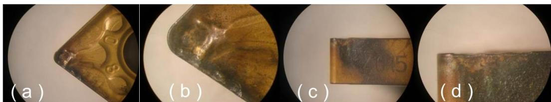
Figura 4. Desgaste do gume(a), desgaste da face(b),
