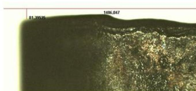
Figura 7. - Ampliação de 50 vezes (desgaste de flanco de 81,39534  $\mu$ ).
