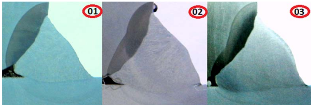
Figura 3 - Macrografia dos corpos de prova soldados sem pré-aquecimento e sem pós-aquecimento. (01) Um cordão de solda, (02) dois cordões de solda e (03) três cordões de solda.
