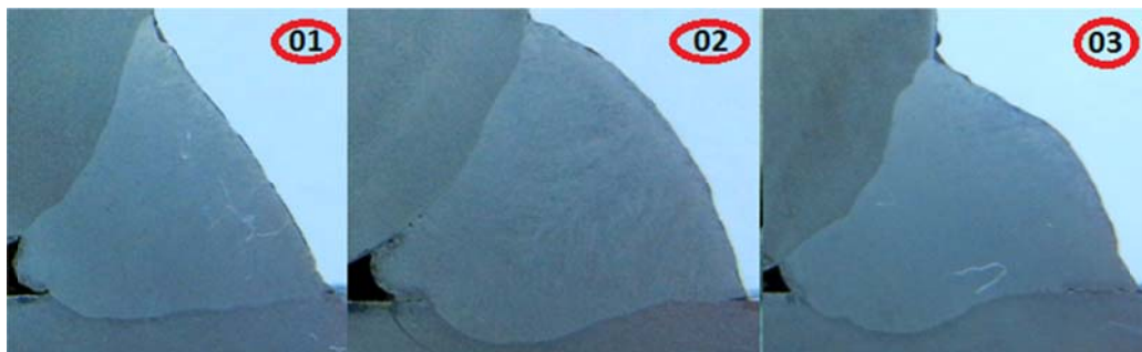
Figura 5 - Macrografia dos corpos de prova soldados com pré-aquecimento e pós-aquecimento. (01) Um cordão de solda, (02) dois cordões de solda e (03) três cordões de solda.
