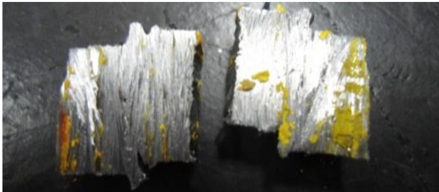
Figura 9. Corpo de prova unido e cortado transversalmente.
