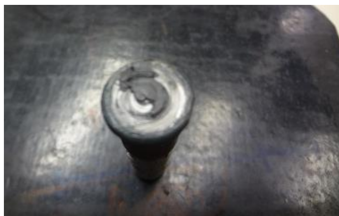
Figura 10. Ruptura do corpo de prova 3.
