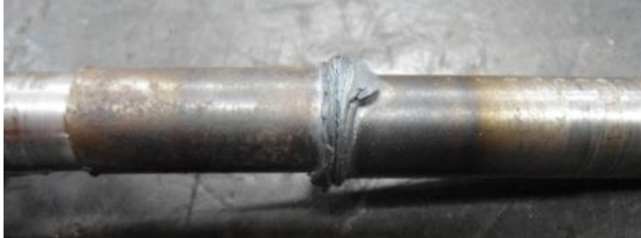
Figura 06. Teste 2 (630rpm) com formação de rebarba regular.
