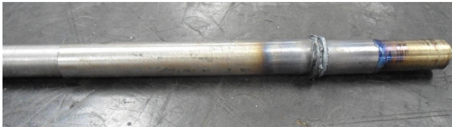
Figura 07. Teste 3 (500rpm) com alinhamento perfeito.
