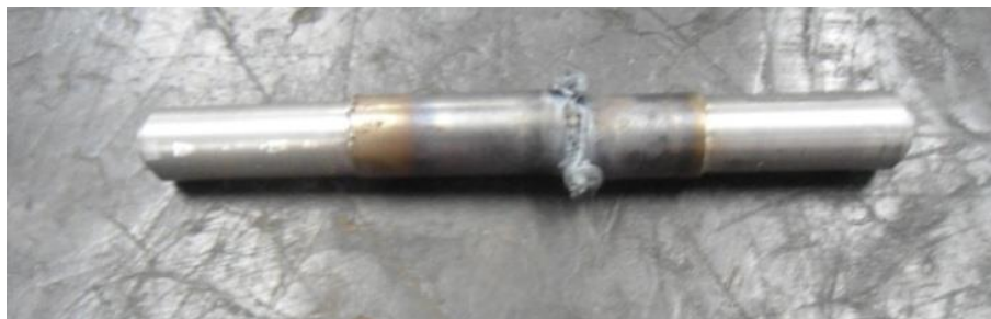
Figura 05. Teste 1 (1000rpm) com formação de rebarba irregular.
