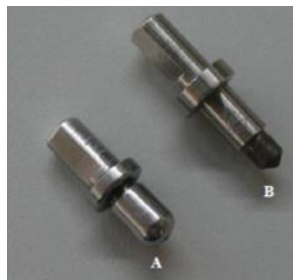
Figura 6. Penetradores esférico (A) e diamante (B).
