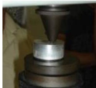
Figura 3. Corpo de prova disposto no durômetro marca Pantec modelo RBS.
