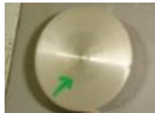
Figura 4. Corpo de prova com a indicação da calota obtida no ensaio de dureza.
