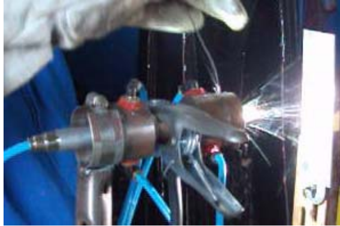
Figura 5. Aspersão térmica com a tocha de plasma.
