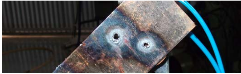
Figura 7. Corpo de prova cortado com tocha de plasma.
