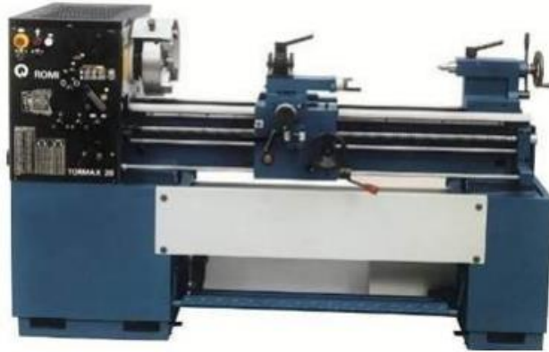
Figura 4: Torno convencional horizontal utilizado para os ensaios de usinagem e análise de rugosidade
