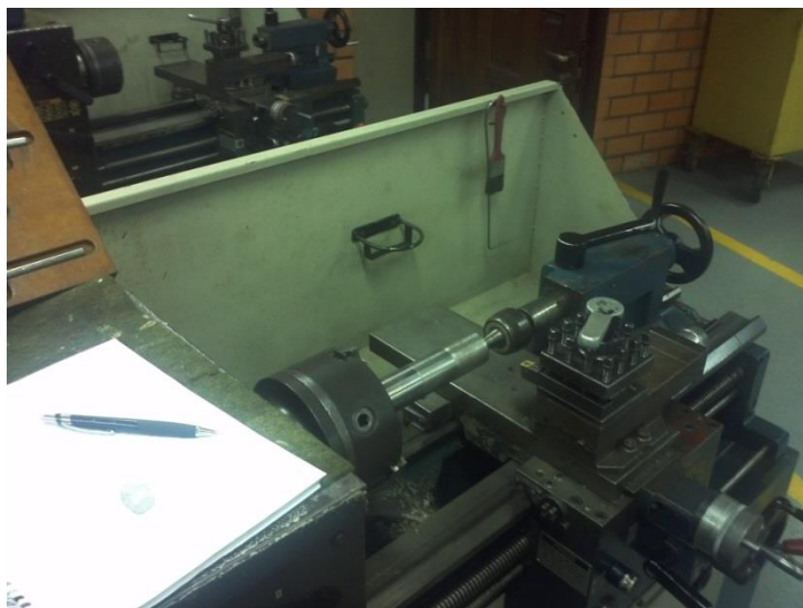
Figura 6: Corpo de prova acoplado ao torno em ensaio de rugosidade.
