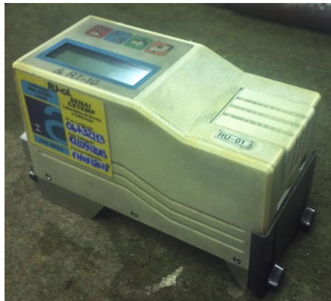
Figura 5: Rugosímetro utilizado para medição da rugosidade nos ensaios de usinagem.
