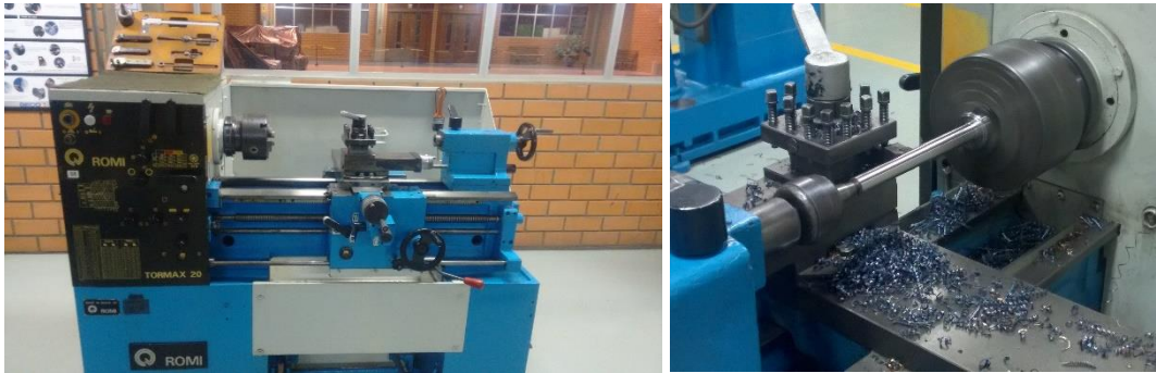
Figura 2: (a) Torno mecânico convencional; (b) Usinagem das amostras.
