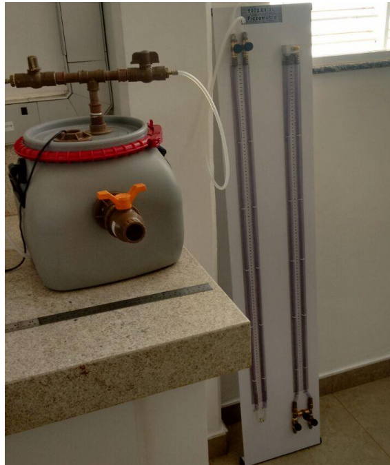
Figura 3: Biodigestor com demonstração do piezômetro em “U”
