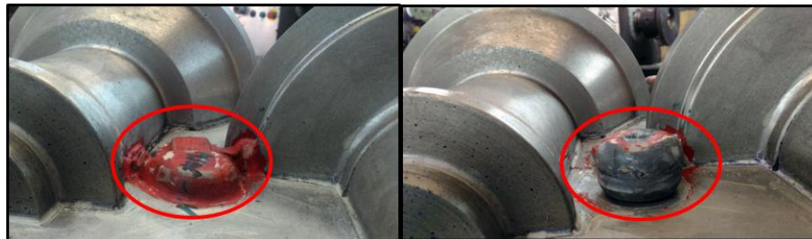
Figura 9: Fixação dos massalotes à placa.
