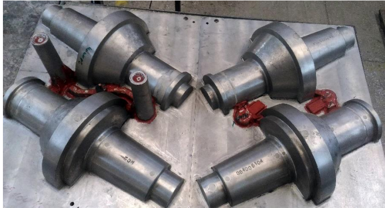
Figura 6: Modelo utilizado para a fundição do metal base.
