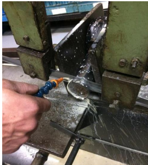
Figura 3: Processo de corte do corpo de prova.
