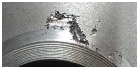
Figura 1: Característica da falha (Porosidade).
