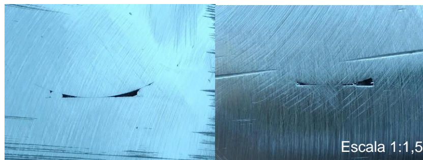
Figura 8: Fissuras da amostra pré-aquecida
