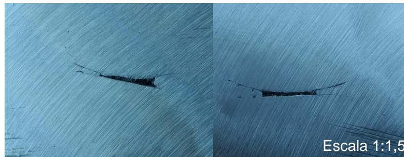
Figura 7: Fissuras da amostra sem tratamento térmico
