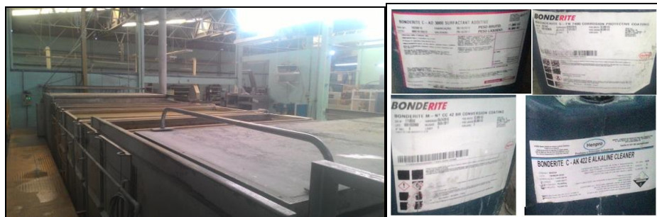
Figura 3: Tanques de lavagem (esquerda) produtos utilizados (direita).
