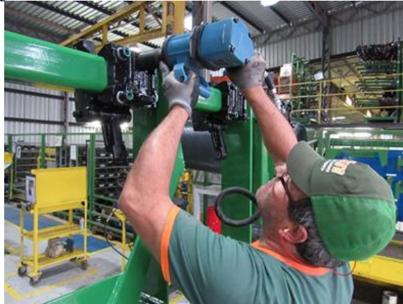
Figura 1: Montagem do conjunto desarme automático no escarificador menor.
