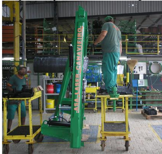
Figura 2: Utilização de carros kit para compensar altura na montagem.
