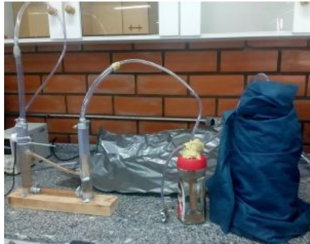
Figura 6 - Sistema de medição de biogás
