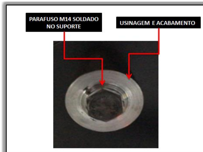
Figura 3 - Soldagem do parafuso M14
