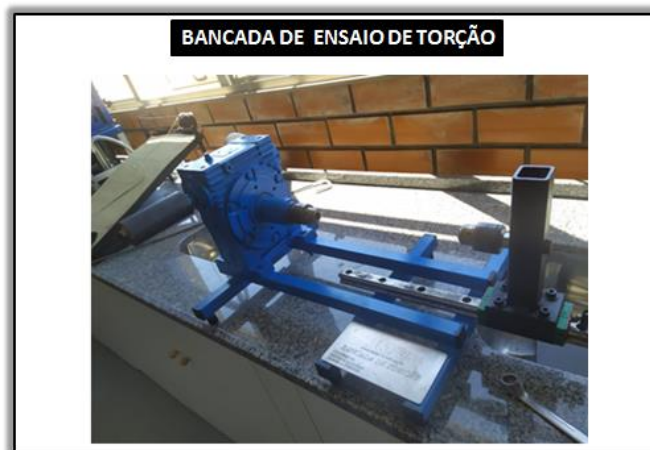
Figura 5 - Bancada de ensaio de torção pronta para realização dos testes
