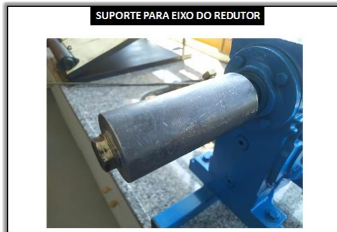
Figura 4 - Suporte para eixo do redutor pronto e montado na bancada.
