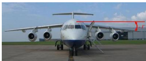
Figura 3. Exemplo de uma asa com ângulo de diedro (RODRIGUES: 2013)
