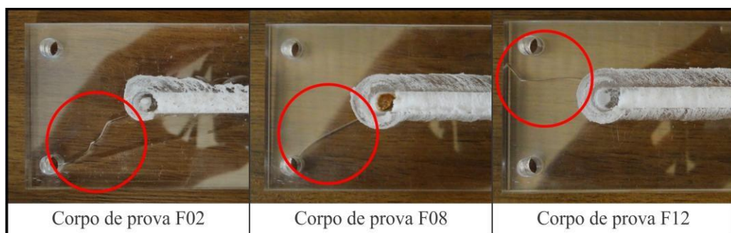
Figura 6. Corpos de prova trincados.
