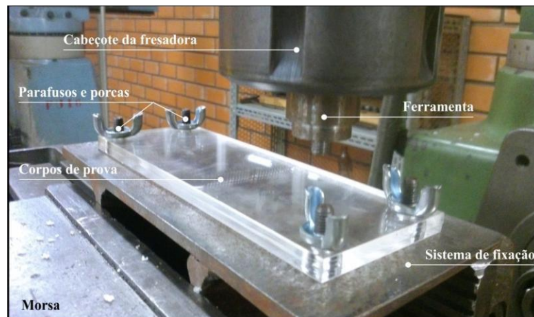
Figura 3. Detalhe do sistema de fixação.
