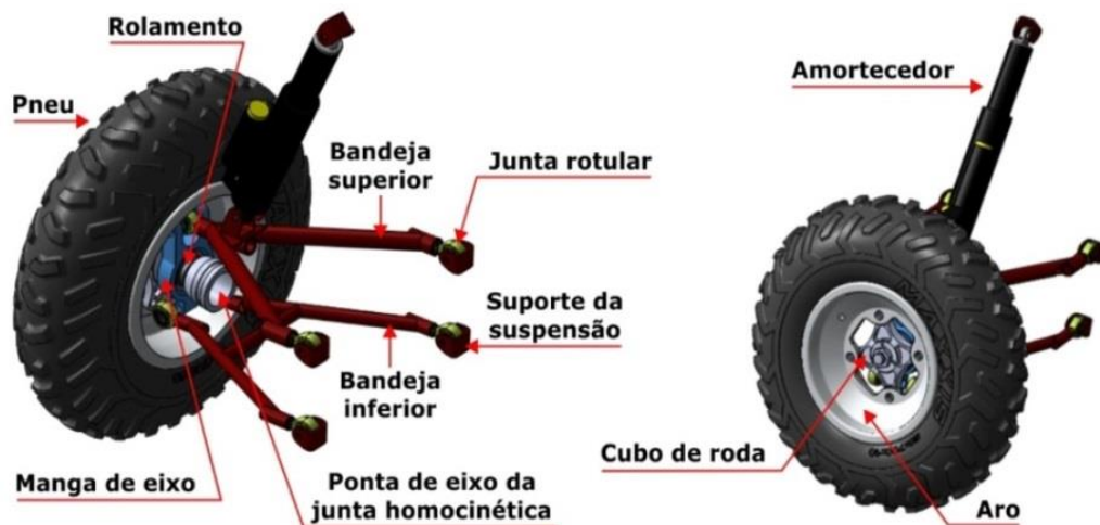
Figura 1: Componentes da suspensão traseira do veículo Baja Sinuelo V.
